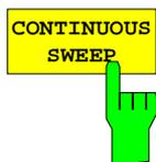
Der Softkey *CONTINUOUS SWEEP* startet den kontinuierlichen Meßablauf. Der tatsächliche Start einer Messung kann dabei von einem externen Triggerereignis abhängen (siehe Abschnitt "Triggereinstellungen - Menü TRIGGER).
