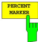
Der Softkey *PERCENT MARKER* setzt den Marker auf den angegebenen Prozenzwert der Y-Achse. Die Schrittweite der Markerbewegung ist dabei abhängig vom aktuellen Marker-Wert.
