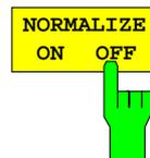
Mit Hilfe des Softkeys *NORMALIZE ON / OFF* kann der DC-Offset des Signals entfernt werden. Grundeinstellung des Parameters ist OFF.
