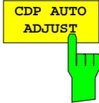
Der Softkey *CDP AUTO ADJUST* paßt die Einstellungen der CDP-Messung automatisch so an, daß eine gültige Messung am Signal mit hoher Wahrscheinlichkeit möglich ist. Dazu werden
