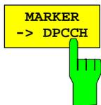
Der Softkey *MARKER -> DPCCH* setzt den Marker auf den Dedicated Physical Common Control Channel (Code-Nummer 0 auf Zweig Q bei Spreading-Faktor 256). Diese Marker-Funktion ist nur dann verfügbar, wenn eine CDP-Darstellung von Zweig Q aktiv ist.
