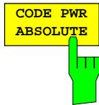
Der Softkey *CODE PWR ABSOLUTE* wählt die Darstellung der Code-Domain-Power in absoluter Skalierung aus.
