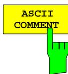
Der Softkey *ASCII COMMENT* aktiviert die Eingabe eines Kommentars zum ASCII-Datensatz. Für den Kommentar stehen maximal 60 Zeichen zur Verfügung.
