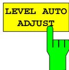
Der Softkey *LEVEL AUTO ADJUST* bewirkt eine automatische Einstellung der HF-Dämpfung und des Referenzpegels auf den Pegel des angelegten Signals. Eine manuelle Nachjustierung mit Softkey *REF LEVEL* ist zulässig.
